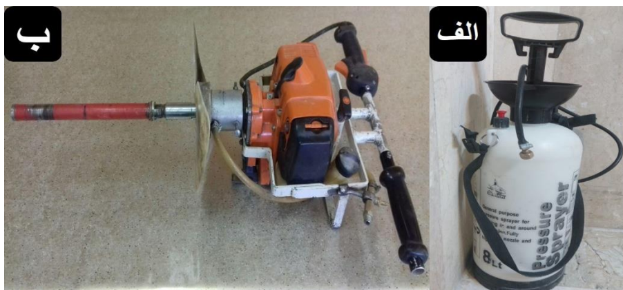
شکل ۴-۳- الف، پمپ آب؛ ب، موتور مغزه‌گیر.
