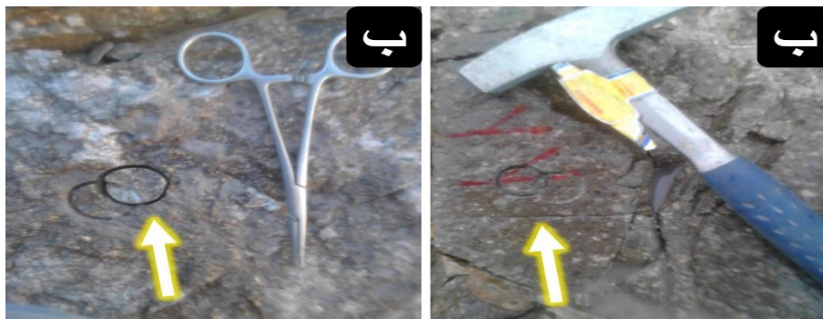
شکل ۴-۴- ترسیم خط یا ایجاد اشکال دایره ای برای باز گرداندن مغزه به حالت اولیه (در صورتی که مغزه شکسته یا جابه جا شود).
