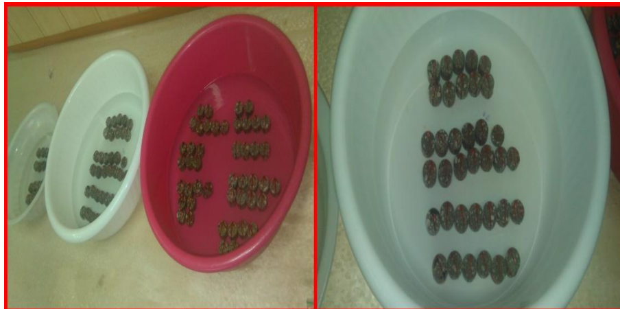
شکل ۴-۸- قطعه مغزه‌های به دست آمده در اسید کلریدریک ۱/۰ نرمال به مدت ۲ ساعت قرار می‌گیرند.
