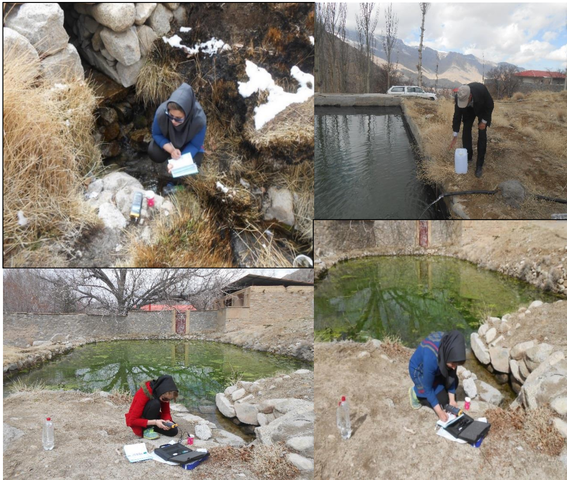
شکل ۳-۲: نمونه‌برداری از منابع آب زیرزمینی شیرکوه و اندازه‌گیری پارامترهای صحرایی (EC، pH و دما)
