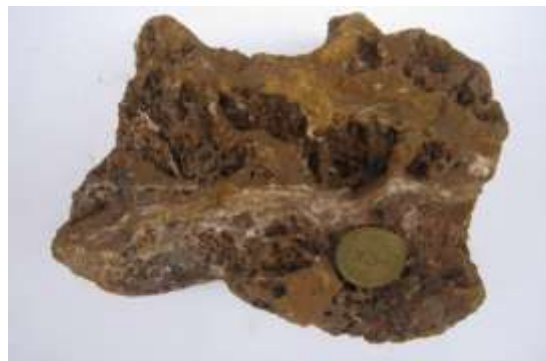
شکل ۵-۱۶: تصویری از ساخت انحلالی در سنگ میزبان کربناته.
