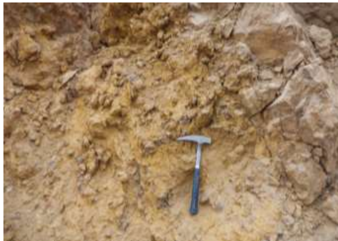
شکل ۴-۹: لیمونیتی شدن میزبان کربناته در کانسار آهن زردکوه.
