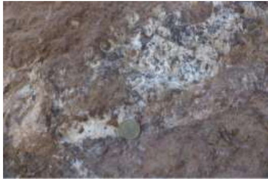
شکل ۵-۱۸: تصویر صحرایی از هماتیت و باریت به صورت پراکنده در میزبان کربناته.
