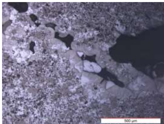
شکل ۵-۲۳: تصویر میکروسکوپی از هماتیت و گوتیت با بافت کلوفورمی در سنگ میزبان کربناته.
