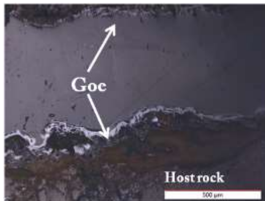
شکل ۵-۱۹: تشکیل گوتیت در حاشیه شکستگی‌های موجود در سنگ میزبان کربناته.
