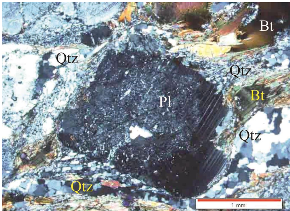
شکل ۳-۲۴: مجموعه‌های چند بلوری کوارتز با حاشیه مضرس در بین کانی پلاژیوکلاز و بیوتیت (نور XPL). علائم کانی‌ها از کرتز (۱۹۸۳) اقتباس شده است.
