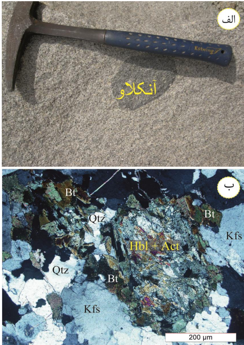
شکل ۳-۱۲-الف: تصویری از آنکلاوهای تونالیتی موجود در سنگ‌های توده لخشک. ب: کانی‌های پیروکسن موجود در این آنکلاوها که توسط هورنبلند سبز و اکتینولیت جایگزین شده‌اند.
