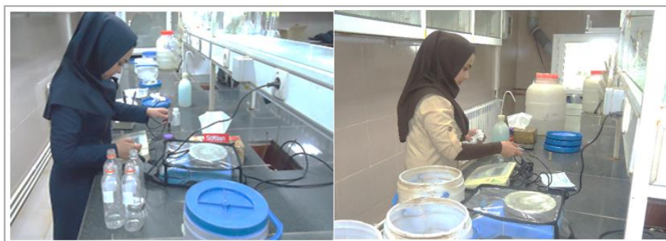
شکل ۳-۱۰: اندازه‌گیری pH و دما در محل معدن با استفاده از دستگاه Mettler Toledo مدل MP 225
