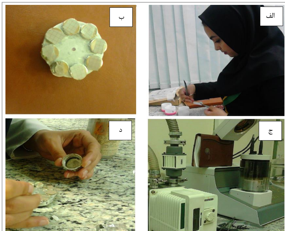
شکل ۳-۸: مراحل آماده‌سازی نمونه‌های بارش خشک برای مطالعات SEM-EDX، الف) برش بخش مرکزی فیلترها که تجمع آئروسول‌ها در آن یکسان بود، ب) چسباندن فیلترهای برش خورده بر روی مقاطع، ج) قرار دادن مقاطع در دستگاه پوشش کربن، د) محکم کردن فیلترهای کربن‌دار بر روی مقاطع توسط چسب نقره
