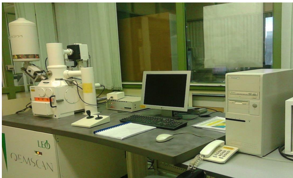
شکل ۳-۷: نمایی از دستگاه SEM-EDX آزمایشگاه کانی‌شناسی سازمان توسعه و نوسازی معادن و صنایع معدنی ایران.
