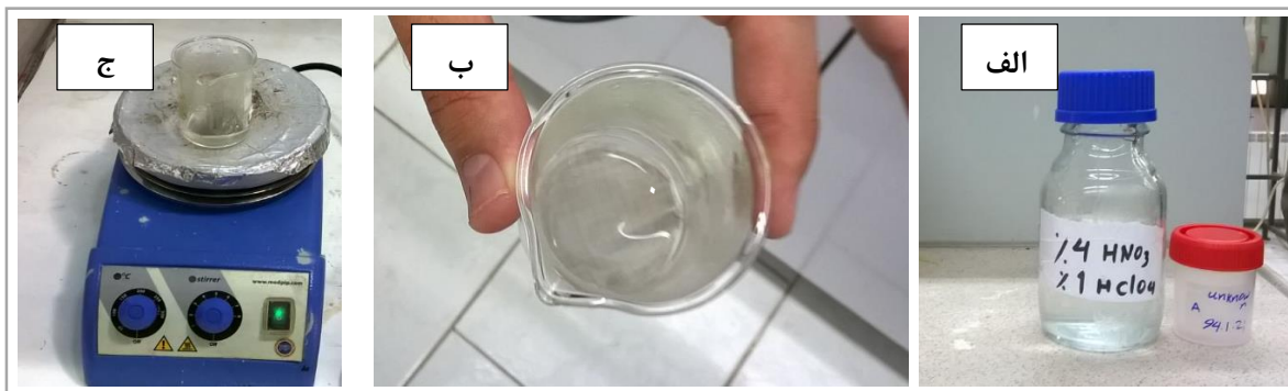
شکل ۳-۶: مراحل مختلف آماده‌سازی نمونه‌ها و استخراج فلزات سنگین از فیلترها؛ الف) تهیه‌ی مخلوط ۱:۴ اسیدپرکلریک و اسید نیتریک، ب) قراردادن فیلترها به مدت ۳۰ دقیقه در ترکیب اسیدی، ج) حرارت دادن محلول حاصل از مرحله قبل در حرارت ۱۵۰ درجه‌ی سانتیگراد
