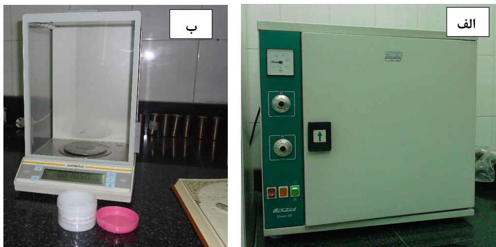
شکل ۳-۵: الف) خشک کردن فیلترها پیش از توزین با استفاده از دستگاه دسیکاتور Behdad مدل Oven50، ب) توزین فیلترها با ترازوی Sartorius (دقت ۰/۰۰۰۰۱ گرم)
