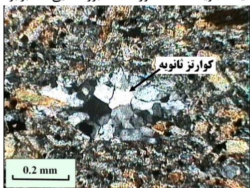
شکل ۸-۶- تصویر میکروسکوپی نشان‌دهنده سیلیس‌زایی در تراکیت‌های آتشفشانی. حفرات از کوارتز پر شده است (نور XPL بزرگنمایی ۱۰۰ برابر).
