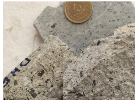
شکل ۳-۱۹- تصویری از نمونه داسیتی به رنگ خاکستری روشن دارای بافت پورفیری که دارای پورفیرهای پلاژیوکلاز و هورنبلند است (محل نمونه- برداری جنوب احمدجامی).
