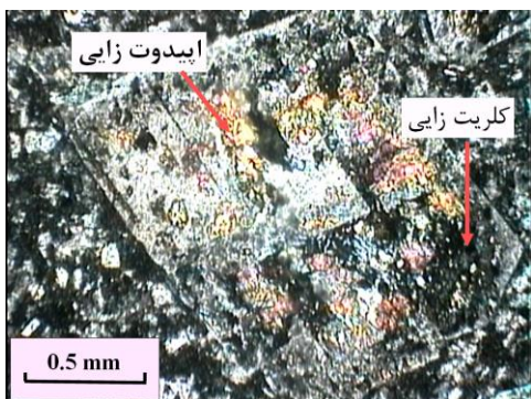
شکل ۳-۲۶- تصویر میکروسکوپی حضور اپیدوت و کلریت در پلاژیوکلاز. لازم به ذکر است کلریت حاصل دگرسانی ادخال‌های اولیه مافیک (عمدتاً هورنبلند) موجود در پلاژیوکلازها می‌باشد (نور XPL، بزرگنمایی ۴۰ برابر).
