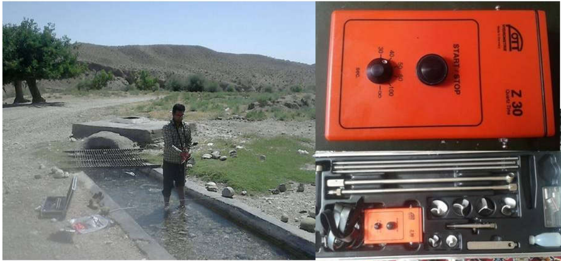
شکل ۳-۱- اندازه‌گیری آبدهی به کمک مولینه در چشمه-قنات محمدآباد
