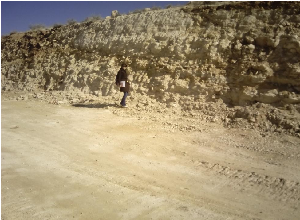
شکل ۴-۱۹- لایه‌های مارنی نازک لایه و سست در لایه آهک در مجاورت چاه‌ها
