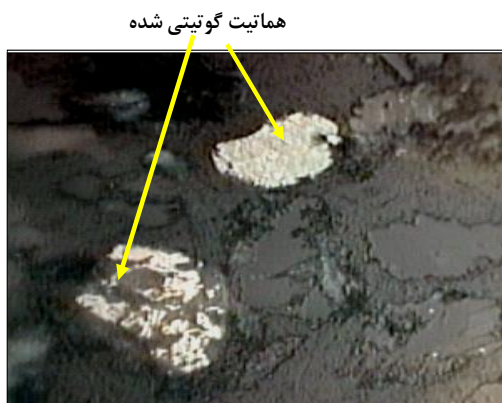
شکل ۷-۵: هماتیت گوتیتی شده در نمونه رسوبات ایستگاه ۳ در سیریک (مقطع صیقلی) (تصویر ۴۰۰ برابر بزرگ شده است)
