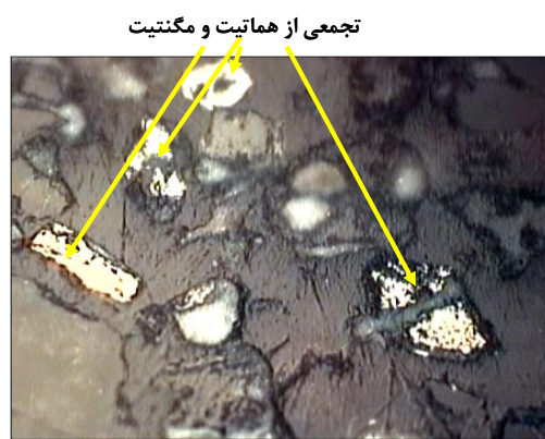
شکل ۷-۶: تجمعی از هماتیت و مگنتیت در نمونه رسوب ایستگاه ۱ در بندر سیریک (مقطع صیقلی) (تصویر ۲۰۰ برابر بزرگ شده است)
