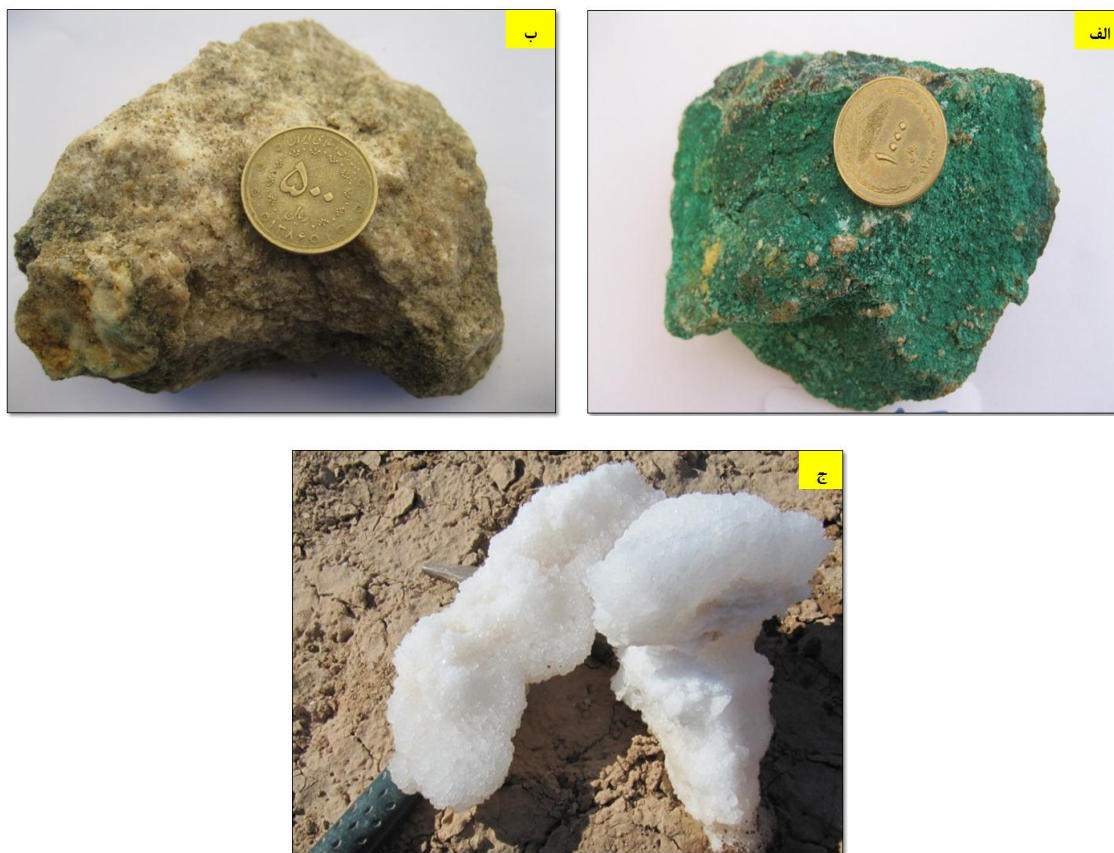
شکل ۵-۱۶: تصاویر نمونه دستی از ساخت توده‌ای کانی‌های مالاکیت (الف)، سلسیت (ب) و هالیت (ج).
