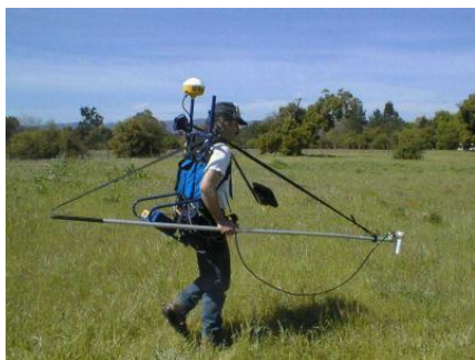
شکل ۵-۲: ساختار نمادین (راست) و نمایی از کار با مغناطیس سنج Proton Precession
