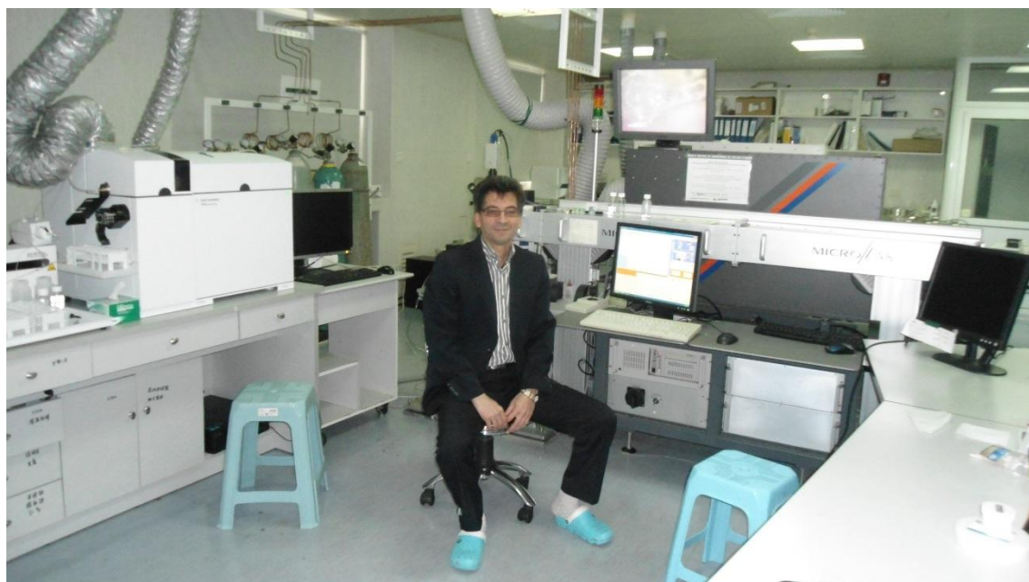
شکل ۱-۶- دستگاه تعیین سن از نوع MICROLAS جهت تعیین سن دانه‌های زیرکن جداشده از گرانیت‌ها به روش LA-ICPMS در دانشگاه شیان چین.
