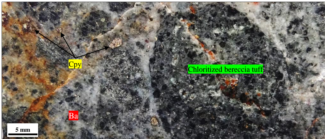
شکل ۵-۸- نمائی از ساخت دانه پراکنده، کالکوپیریت بصورت دانه پراکنده در کمربایین زیرافق چهارم به همراه قطعات سنگ میزبان در باریت و سیلیس (بافت برشی)
