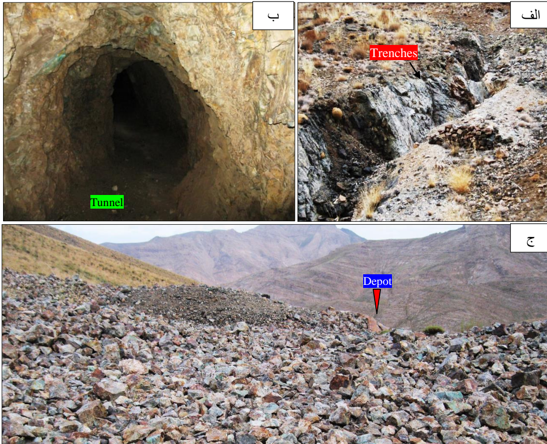
شکل ۱-۵- آثار انفجاری و کندکاری و تونل‌ها در منطقه معدنی ورنندان که نشان از کارهای شدادی قدیمی در منطقه مورد مطالعه دارد. الف- ترانشه در امتداد لایه معدنی باریت در زیرافق دوم، ب- تونل شماره دو در زیرافق سوم کانه‌زائی و ج- دپوهای باطله در کانسار ورنندان
