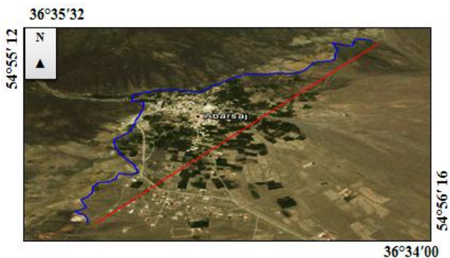
شکل ۴-۴- اندازه گیری پارامترهای لازم برای محاسبه شاخص Smf در حوضه ۱ (خط آبی نشان دهنده Lmf و خط قرمز نشان دهنده Ls می باشد)
