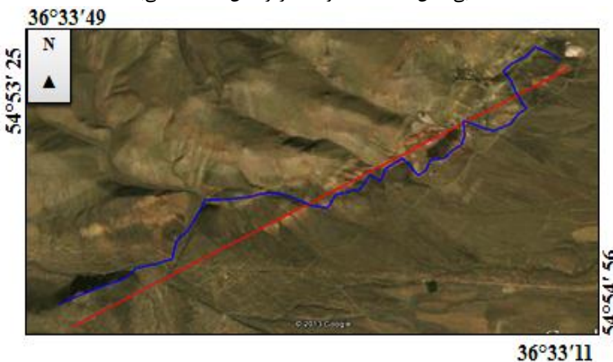
شکل ۴-۵- اندازه گیری پارامترهای لازم برای محاسبه شاخص Smf در حوضه ۲ (خط آبی نشان دهنده Lmf و خط قرمز نشان دهنده Ls می باشد)
