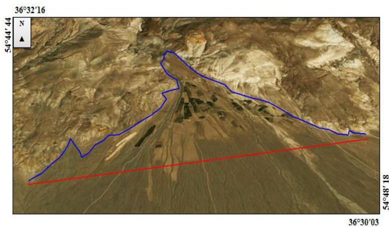
شکل ۴-۷- اندازه گیری پارامترهای لازم برای محاسبه شاخص Smf در حوضه ۴ (خط آبی نشان دهنده Lmf و خط قرمز نشان دهنده Ls می باشد)
