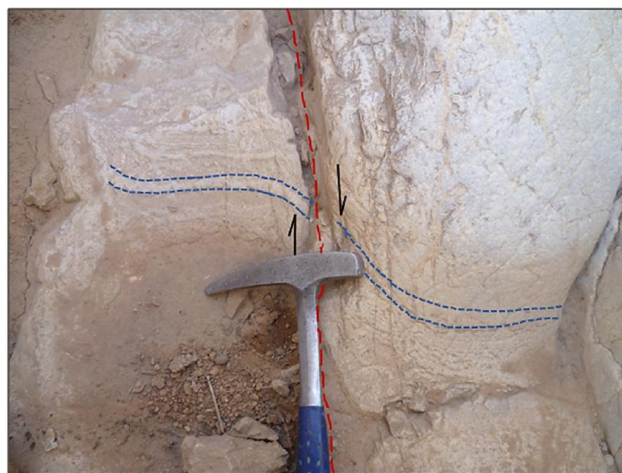
شکل ۳-۶۳- قطع‌شدگی و جابجایی راستبر لامینه در راستای گسل شمالی- جنوبی در سازند لار واقع در ایستگاه ۴.
