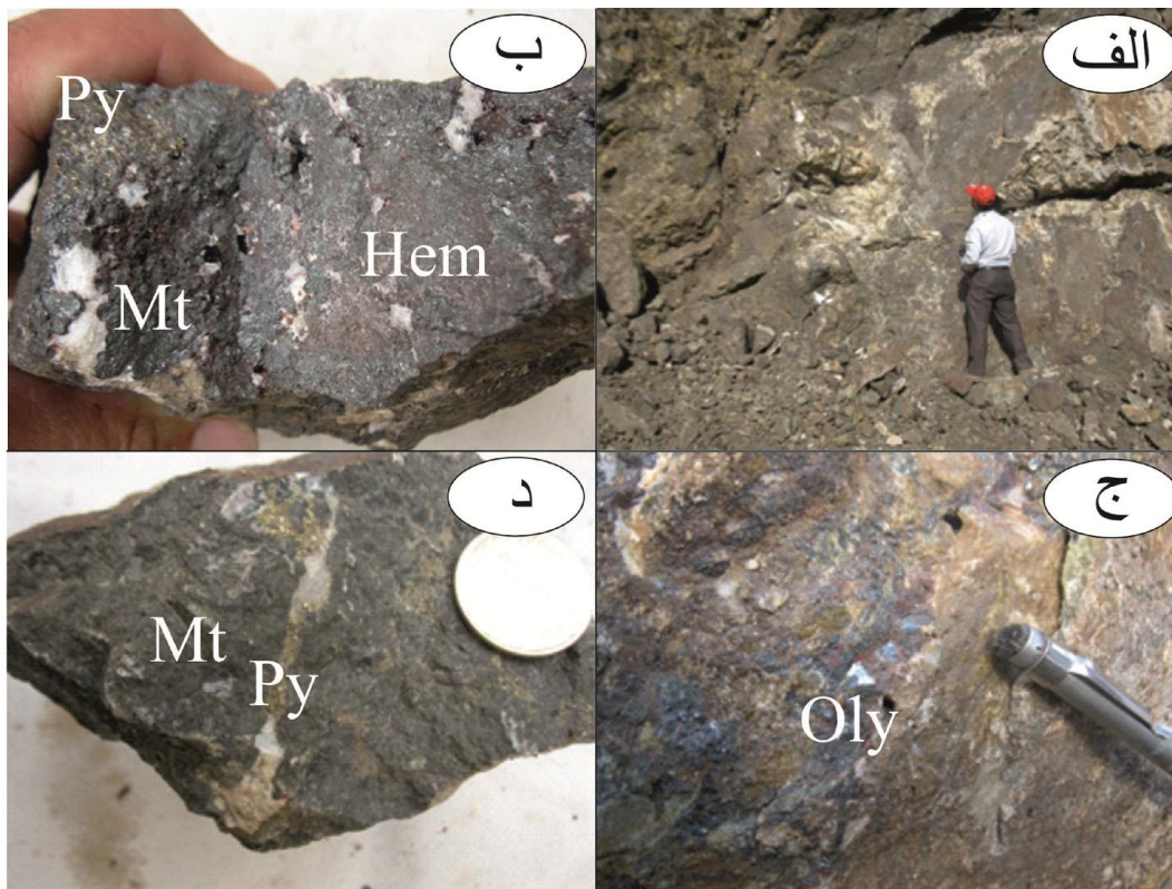
شکل ۳-۴ الف- کان‌زایی توده‌ای مگنتیت (Mt) با لنزهایی از کلسیت، ب- کانسنگ مگنتیتی همراه با هماتیت (Hem) و پیریت (Py)، ج- کان‌زایی اولیژیست (Oly)، د- کان‌زایی پیریت به صورت دانه پراکنده در متن کانسنگ مگنتیتی و رگه‌های تأخیری
