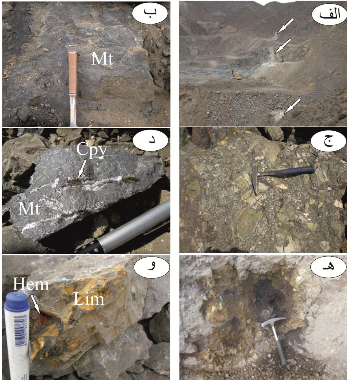
شکل ۴-۷) الف- دایک دگرسان شده (سفید رنگ) در غرب پیکره A3، ب- کانسنگ توده‌ای، ج- کانسنگ برشی، شامل قطعات دگرسان شده سنگ میزبان توفی که فضای بین قطعات را کانی مگنتیت پر کرده است، د- ساخت توده‌ای از بخش جنوبی پیکره A3 همراه با کانه‌زایی کالکوپیریت و کلسیت در حفرات، ه- کانه‌زایی اکسیدهای منگنز، و- لیمونیتی (Lim) و هماتیتی شدن (Hem)
