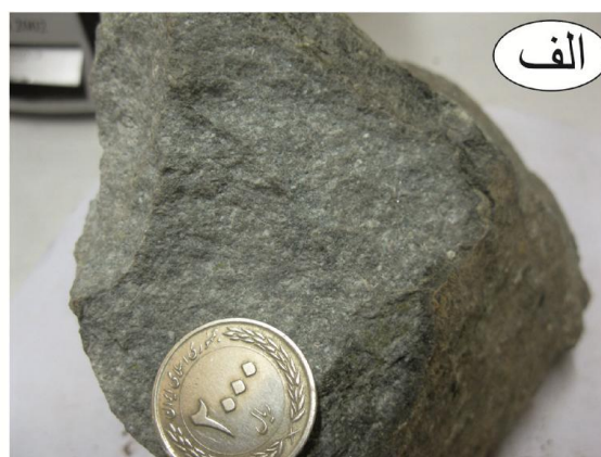
شکل ۸-۳ الف- نمونه دستی از توده نفوذی دیوریتی منطقه ورتاوه، ب- پلاژیوکلاز (Pl) درشت بلور (بالا سمت چپ) و پلاژیوکلازهای دانه ریز در زمینه‌ای از مگنتیت (Mt)، کلریت (Chl) و اپیدوت (Epi).
