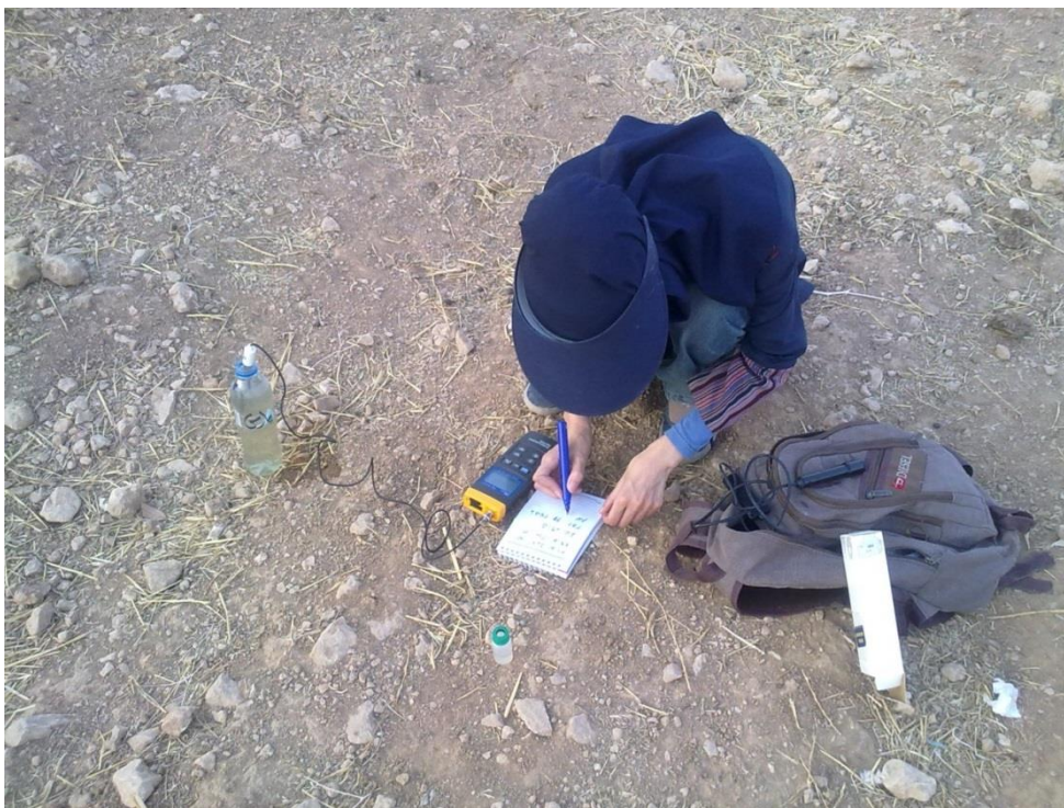
شکل (۳-۲): اندازه‌گیری پارامترهای صحرائی (EC، pH و دما)
