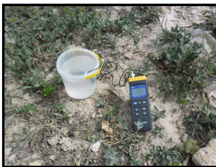
شکل ۳-۲- اندازه‌گیری pH و EC در محل نمونه‌برداری
