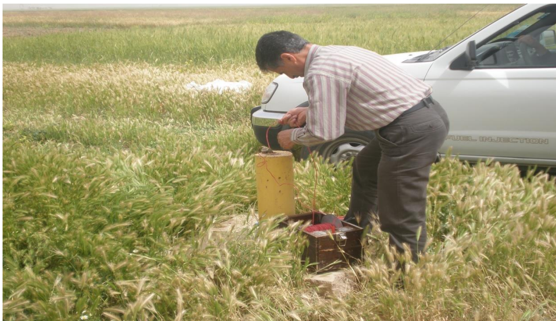
شکل ۳-۲- اندازه‌گیری سطح آب پیژومتر با عمق‌یاب
