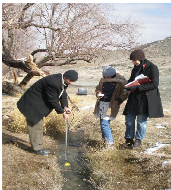
شکل ۳-۱- روش استفاده از مولینه
