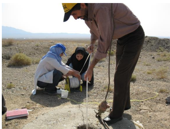
شکل ۴-۶- نحوه اندازه‌گیری هدایت الکتریکی در بالادست یکی از قنات‌های منطقه
