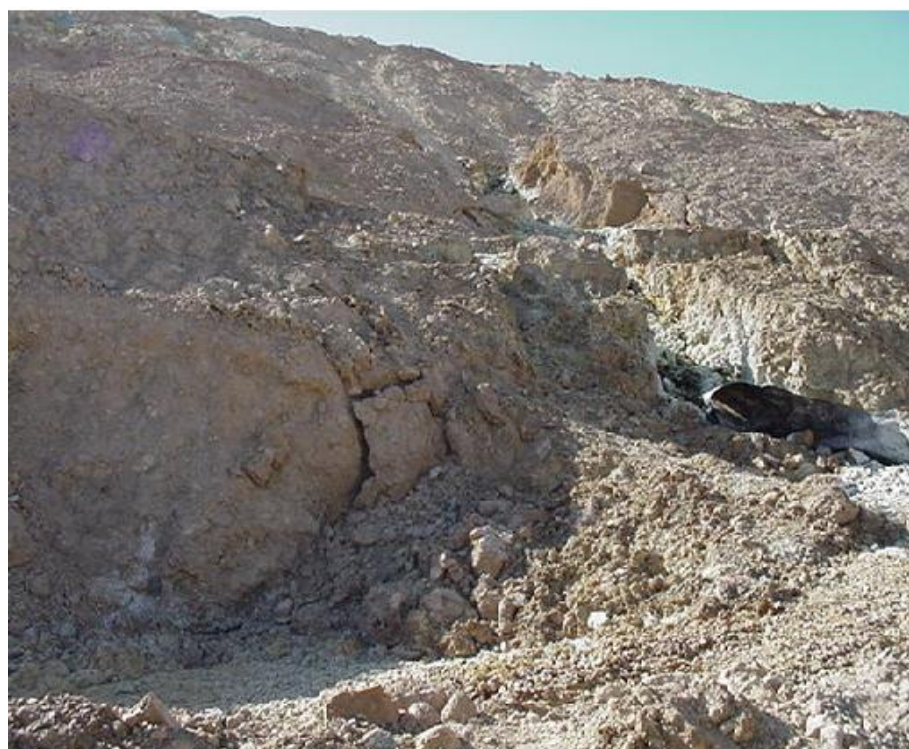
شکل ۴-۷- فرسایش پد در اثر پدیده کانالیزه شدن در هیپ
