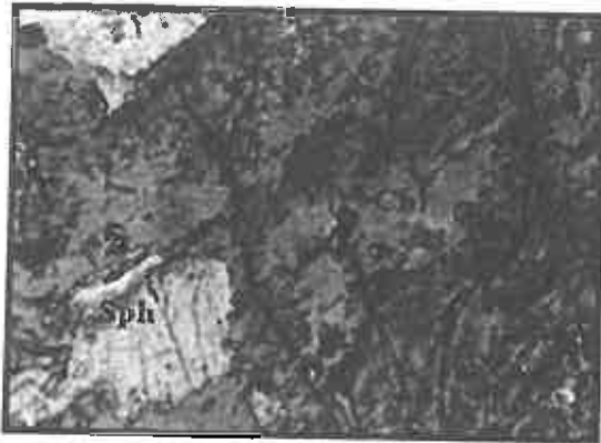
شکل ۳-۱۷- تصویر میکروسکوپی یک نمونه سنگ دیوریتی که در آن کانی هورنبلند به کلریت و اسفن تجزیه شده است (محل نمونه برداری روستای چاه زمین) (XPL، بزرگنمایی ۴۰ برابر). Sph = اسفن، Chl = کلریت
