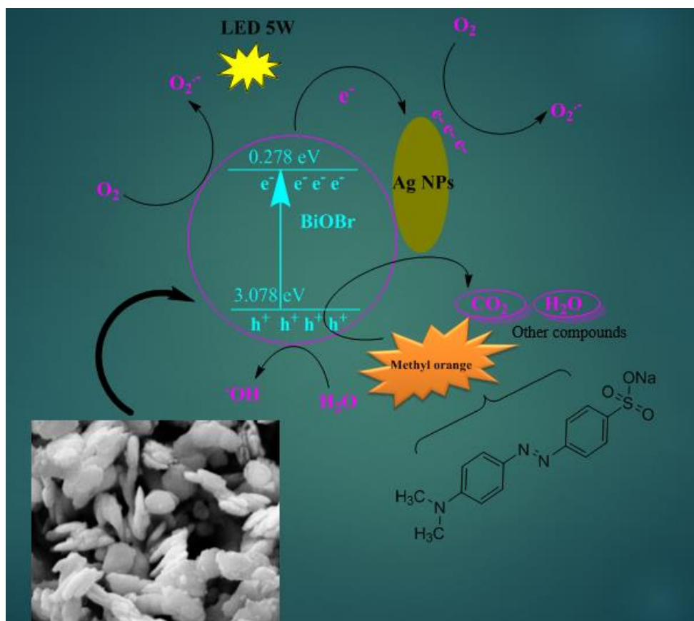
شکل (۳-۳۵) طرحی از انتقال بار در تخریب فتوکاتالیزوری با BiOBr/Ag.
