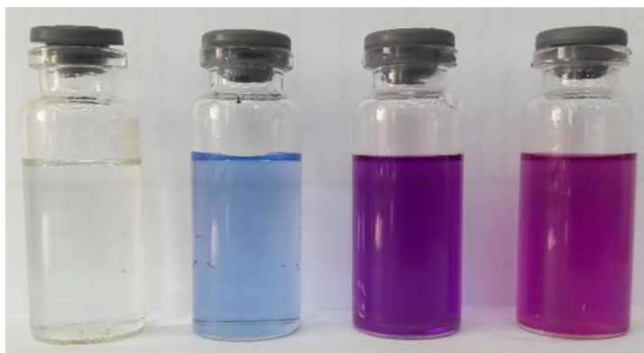
شکل ۲-۲۰: محلول‌هایی از ترکیب ۱،۳،۳'-تری‌متیل-۸-نیتروواسپیرو[کرومن-۲،۳'-ایندولین] (۱ میلی‌مولار) در حلال‌های مختلف مانند استونیتریل، DMF، متانول و اتانول (به ترتیب از چپ به راست)
