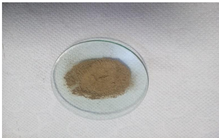
شکل ۳-۳. کاتالیزور (PAMSQ-Ag) سنتز شده در محیط آزمایشگاه
