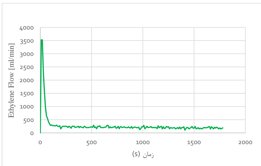
شکل ۲-۵۶ نمودار بررسی اثر زمان بر میزان مصرف مونومر اتیلن کاتالیزور (۴)، آزمون ۱۸.
