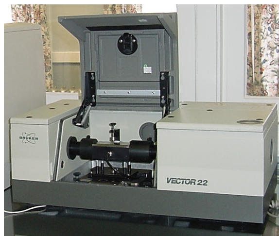
شکل ۲-۳ دستگاه طیف‌سنج زیر قرمز (FT-IR) مدل Bruker model vector 22.
