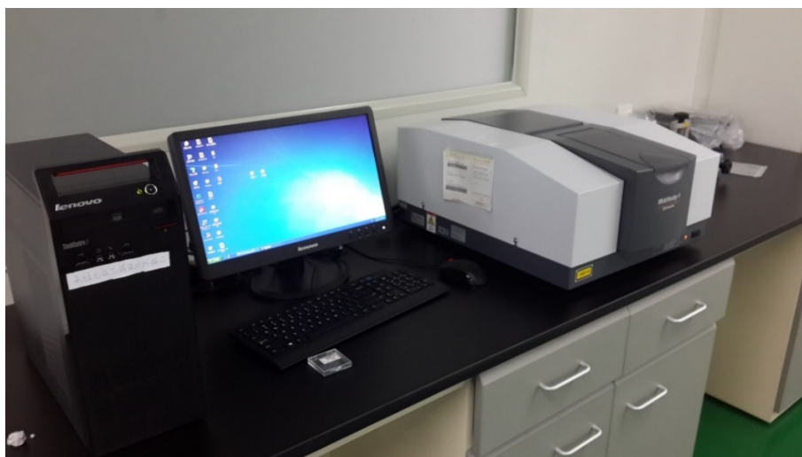
شکل ۱-۳ دستگاه طیف‌سنج زیر قرمز تبدیل فوریه (FT-IR) مدل Shimadzu Model 460.
