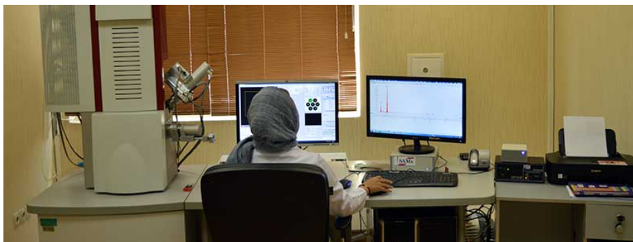
شکل ۳-۸ دستگاه میکروسکوپ الکترونی گسیل میدانی (FE-SEM).
