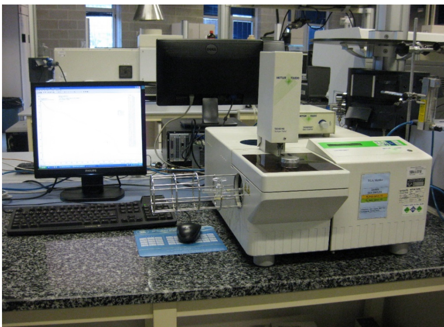
شکل ۳-۴ دستگاه آنالیز وزن سنجی گرمایی (TGA).
