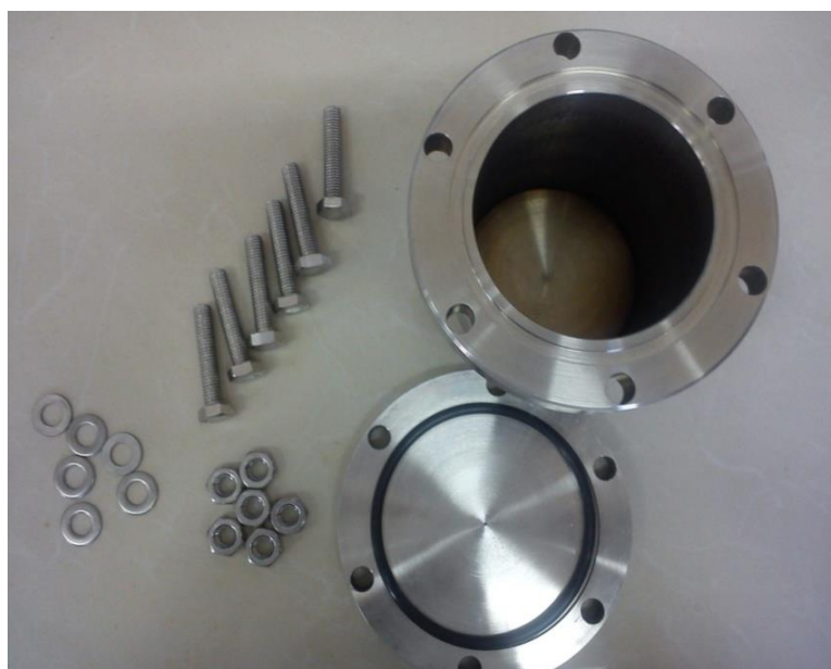
شکل ۱-۹: تصویر اتوکلاو ناپیوسته
