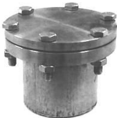
شکل (۱-۲): تصویر راکتور استیل به کار گرفته شده جهت آبکافت هیدروترمال
