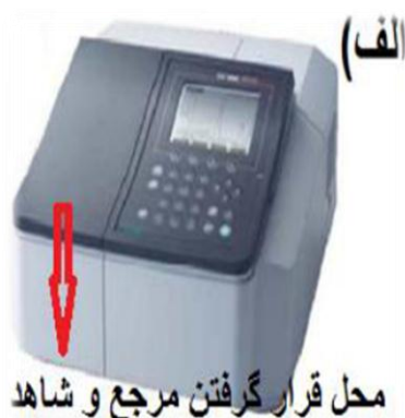
شکل ۳-۱۱: دستگاه اسپکتروفوتومتر (UV-1800 Shimadzu) دانشگاه صنعتی شاهرود.
