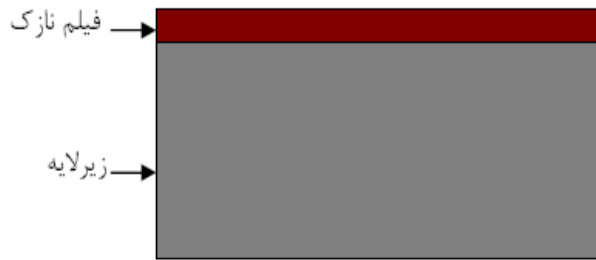
شکل ۱-۳: ساختمان لایه نازک بر روی یک زیرلایه [۴۳].
