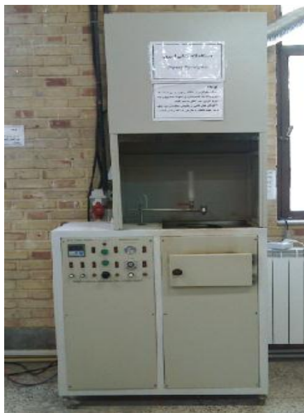
شکل ۴-۱: دستگاه اسپری استفاده شده در این پایان نامه (Spray coating system S.C.S. ۸۶) در دانشگاه صنعتی شاهرود.
