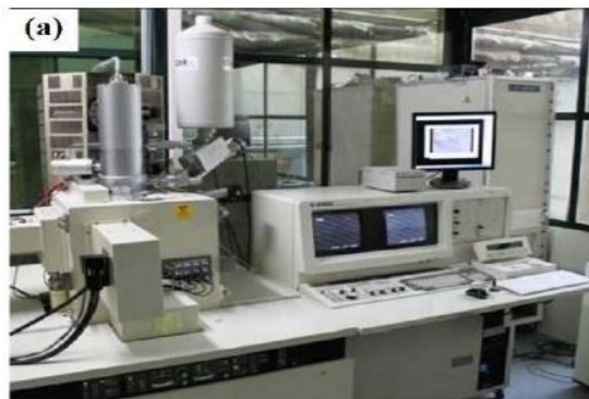
شکل ۳-۱۰: نمایی از میکروسکوپ الکترونی روبشی گسیل میدانی (FESEM) به کار گرفته شده در دانشگاه تهران.
