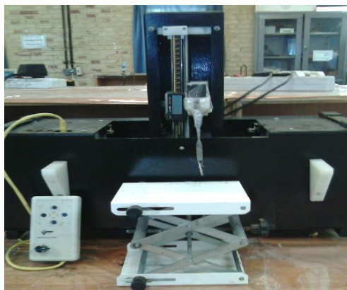
شکل ۴-۴: نمایی از دستگاه سل ژل غوطه‌وری در دانشگاه صنعتی شاهرود.
