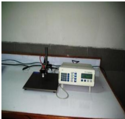
شکل ۵-۱: دستگاه four point probe موجود در آزمایشگاه STM دانشگاه صنعتی شاهرود.
