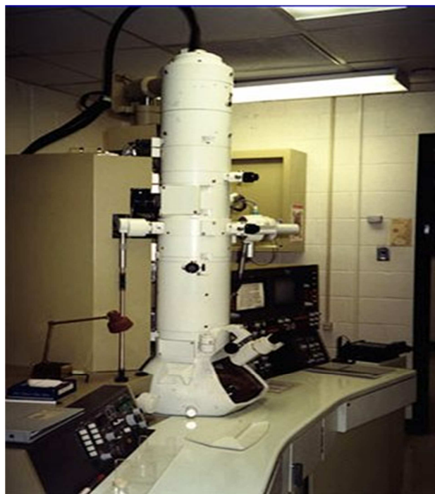
شکل ۲-۸- نمایی از میکروسکوپ الکترونی روبشی تجهیز شده با EDS.
