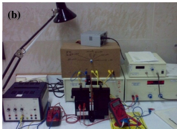
شکل ۲-۲۰- (a) طرحواره‌ای از آزمایش اثر هال و (b) تصویری از دستگاه بکارگرفته شده در آزمایشگاه.
