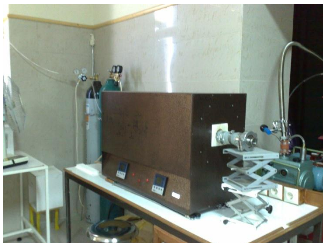
شکل ۱- تصویر کوره الکتریکی افقی دو ناحیه ای تحت اتمسفر گازی و تحت خلاء جهت رشد نانو ساختارهای یک بعدی اکسید فلزی
