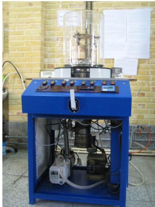
شکل ۵-۲: دستگاه تبخیر حرارتی موجود در آزمایشگاه نانوفیزیک دانشگاه صنعتی شاهرود
