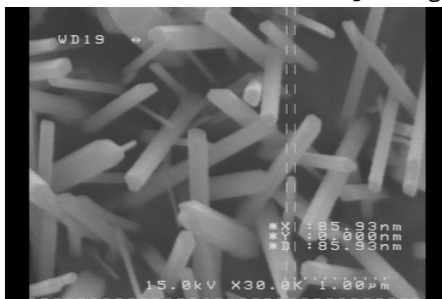
شکل ۳- تصویر SEM از نانو میله های رشد داده شده \text{SnO}_2
