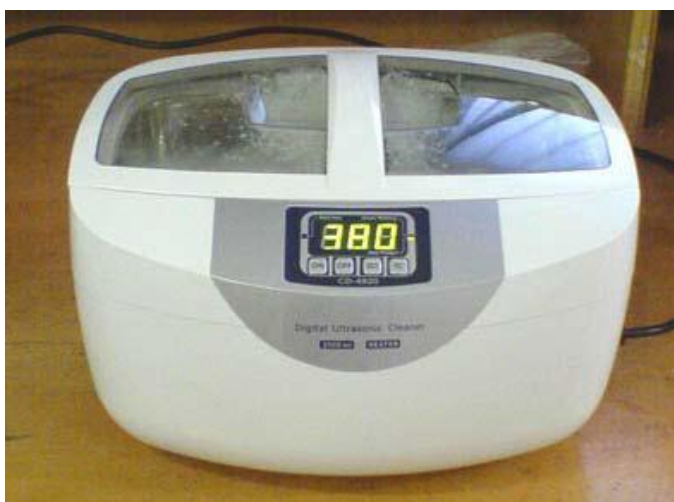
شکل (۲-۳) - دستگاه تمیز کننده آلتراسونیک موجود در آزمایشگاه نانو فیزیک دانشکده فیزیک دانشگاه صنعتی شاهرود.
