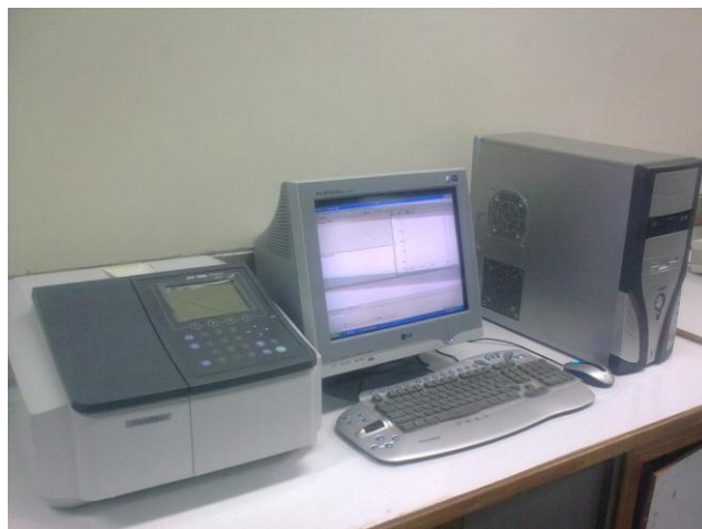
شکل (۳-۲) - شماتیکی از دستگاه اسپکتروفوتومتر مدل UV-160 شرکت Shimadzu واقع در دانشکده فیزیک
