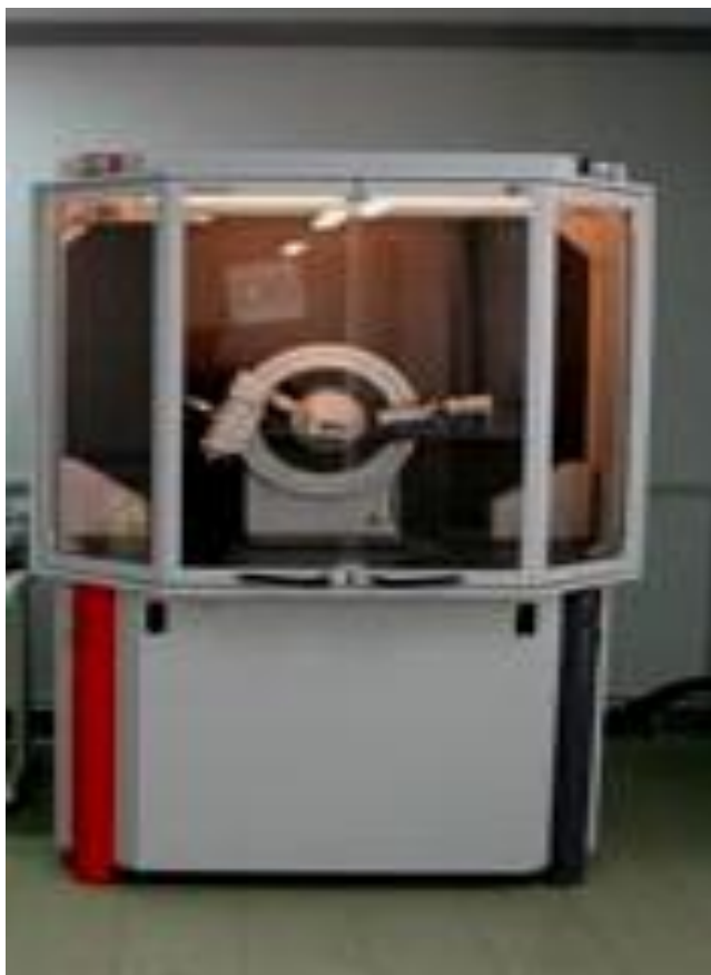
شکل ۲-۳: دستگاه پراش پرتو X مدل Bruker-AXS در دانشگاه دامغان.
