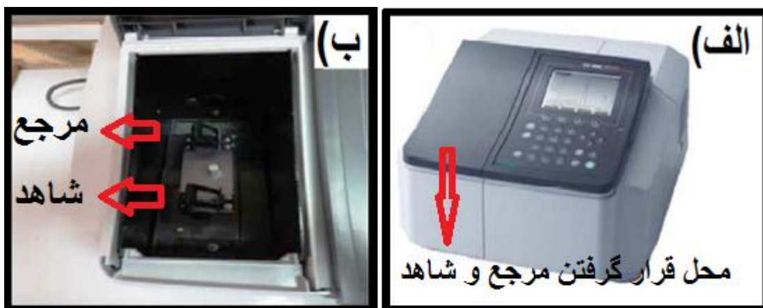
شکل ۴-۲: الف) دستگاه اسپکتروفوتومتر ( Shimadzu UV-1800 ) دانشگاه صنعتی شاهرود. ب) محل قرارگیری
