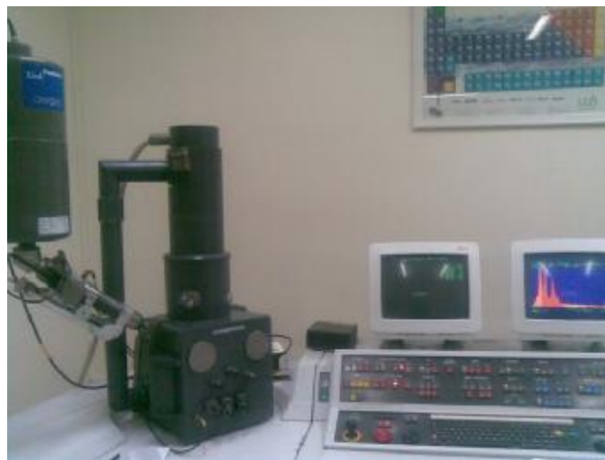
شکل (2-2): دستگاه (SEM) مدل Hitachi S-4160 دانشکده فنی دانشگاه تهران
