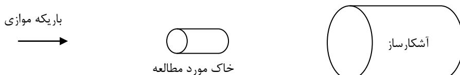
شکل ۳-۵ سامانه شبیه‌سازی شده برای اندازه‌گیری رطوبت خاک به روش تضعیف
