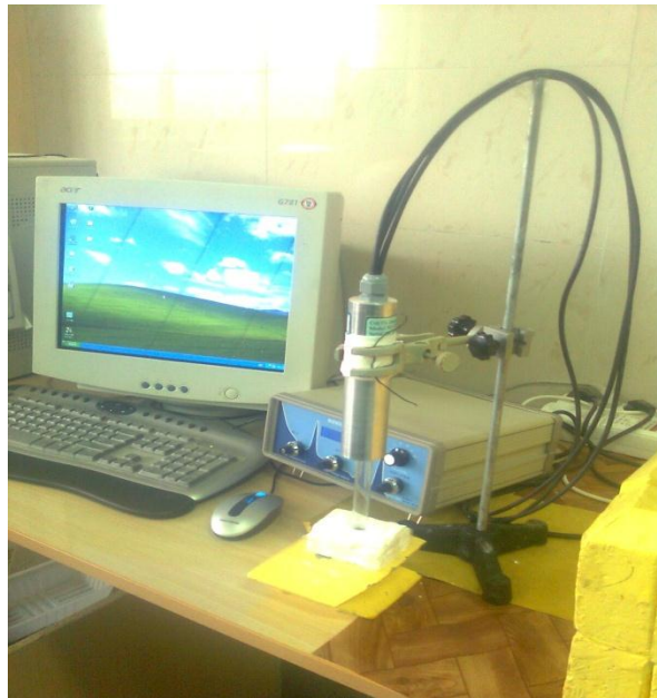
شکل ۱-۴ سامانه طراحی شده برای اندازه‌گیری رطوبت وقتی لوله آزمایش خالی است
