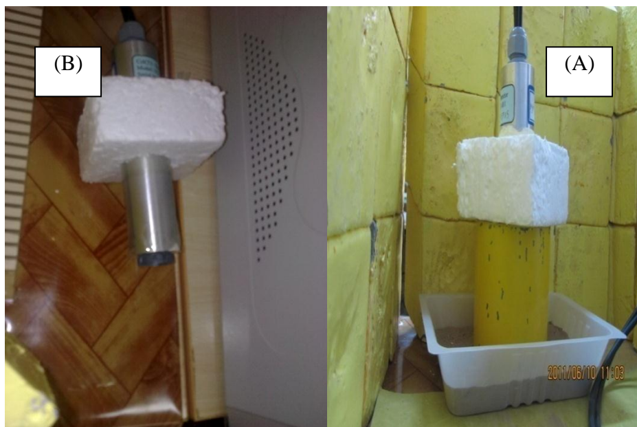
شکل ۳-۴ سامانه طراحی شده برای اندازه‌گیری رطوبت به روش پس‌پراکندگی (A) نشان دهنده حفاظ مربوط به چشمه که روی آشکارساز قرار گرفته است (B) کل سامانه اندازه‌گیری.
