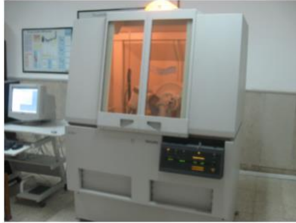
شکل (۲-۳): تصویری از یک دستگاه پراش پرتو X مدل X'Pert Pro واقع در دانشگاه کاشان.
