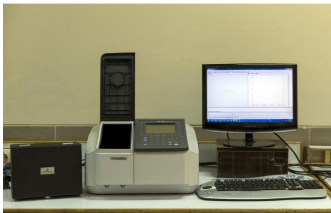
شکل (۳-۶): تصویری از دستگاه طیف سنج UV-Vis واقع در دانشگاه صنعتی شاهرود.
