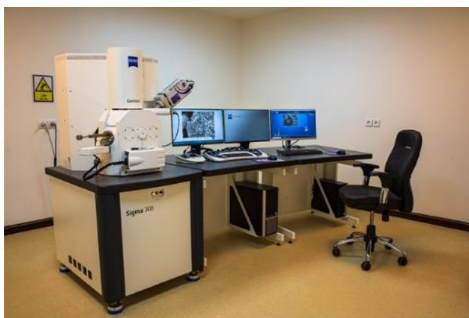
شکل (۳-۵): تصویری از دستگاه میکروسکوپ الکترونی روبشی گسیل میدانی (FESEM) مدل HV 300-Sigma واقع در دانشگاه صنعتی شاهرود.
