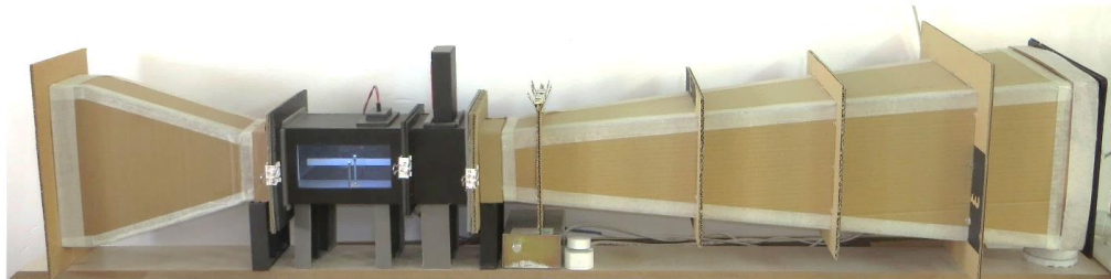
شکل (۳-۲): تونل باد ساخته شده جهت انجام آزمایشات
