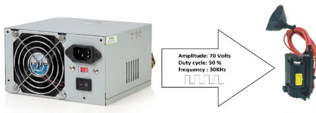
شکل (۳-۱۷): اجزای به کار رفته در منبع ولتاژ بالا
