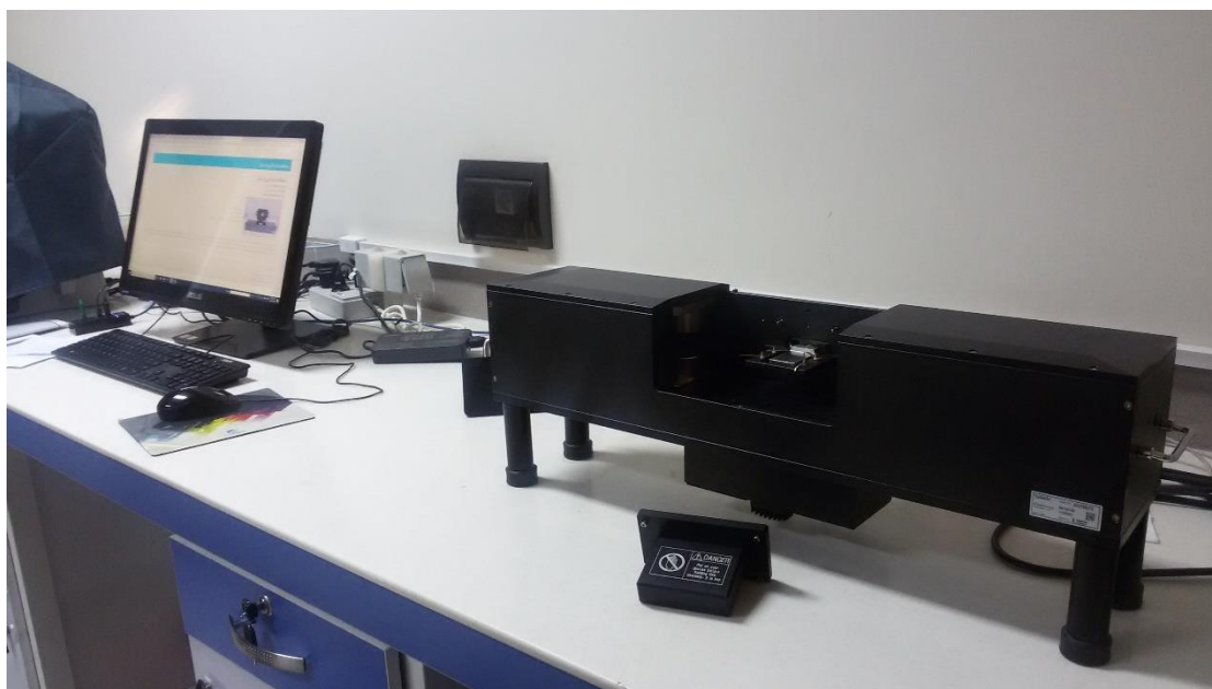
شکل ۲-۶ دستگاه اندازه گیری اثر هال واقع در دانشگاه صنعتی شاهرود
