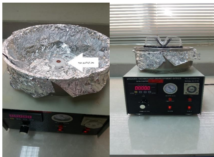
شکل ۲-۲: دستگاه لایه نشانی چرخشی واقع در دانشگاه صنعتی شاهرود.
