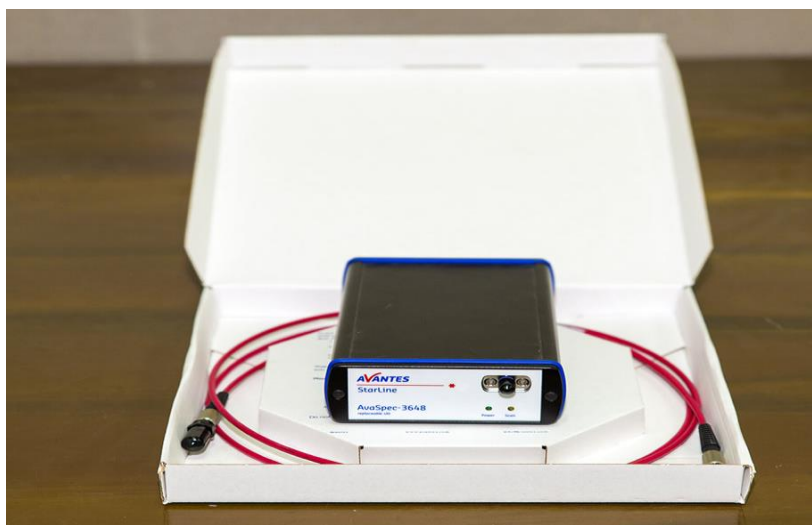
شکل ۲-۵: تصویری از دستگاه طیف سنج نشر نوری (OES) واقع در دانشگاه صنعتی شاهرود
