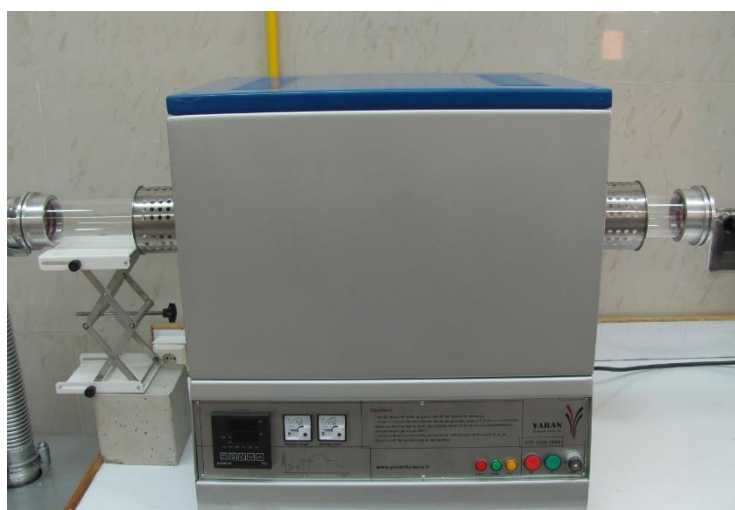
شکل ۳-۲: کوره تیوبی 1600^{\circ}\text{C} واقع در پژوهشکده مواد و انرژی کرج
