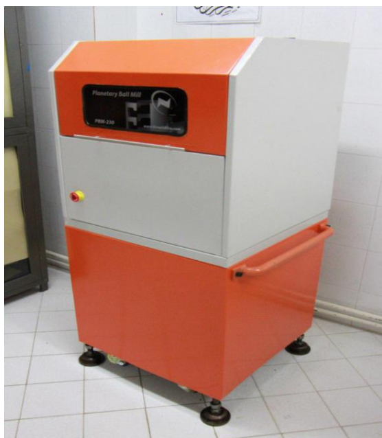
شکل ۳-۱: آسیاب سیاره‌ای پرانرژی واقع در دانشگاه صنعتی شاهرود
