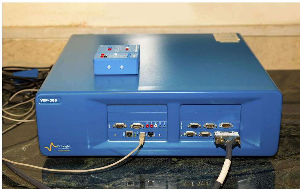
شکل ۲-۸: دستگاه گالوانواستات/پتانسیواستات استفاده شده واقع در دانشگاه صنعتی شاهرود
