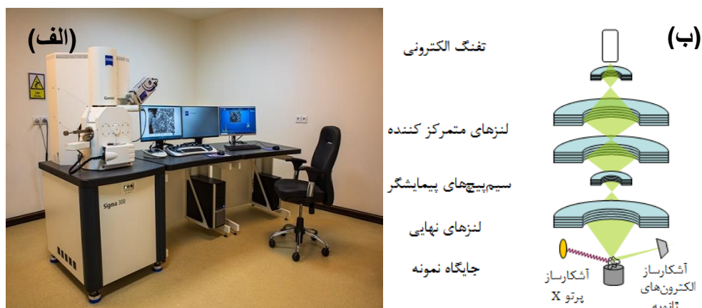
شکل ۲-۳: (الف) میکروسکوپ الکترونی روبشی گسیل میدانی (FESEM) بکار گرفته شده در مورفولوژی سطح نمونه‌ها و (ب) تصویر شماتیک از اجزاء داخلی مسیر عبور باریکه الکترونی تا سطح نمونه
