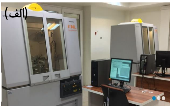
شکل ۲-۲: (الف) دستگاه پراش پرتو ایکس واقع در دانشگاه صنعتی شریف، (ب) نمایی شماتیک از پراش پرتو ایکس منعکس شده در یک بلور
