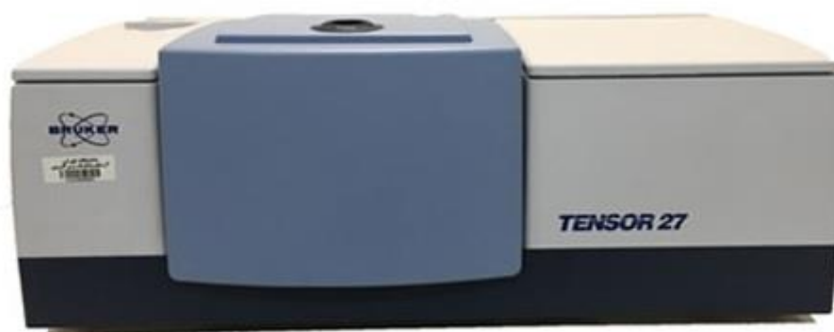
شکل ۲-۴: دستگاه FTIR-ATR استفاده شده واقع در دانشگاه تهران
