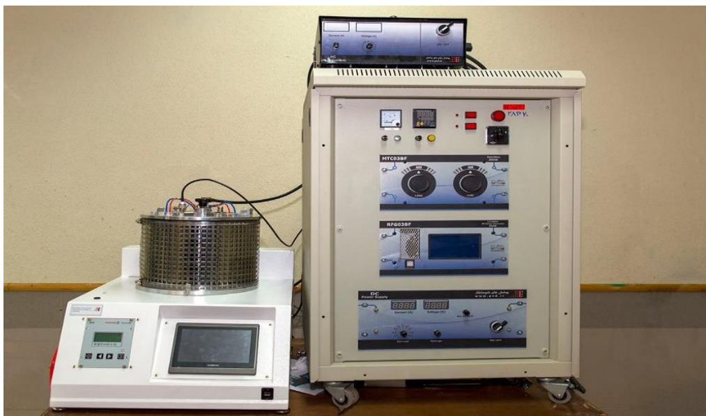
شکل ۳-۶: دستگاه اسپاترینگ ۳ کاتده به همراه تبخیر حرارتی واقع در دانشگاه صنعتی شاهرود
