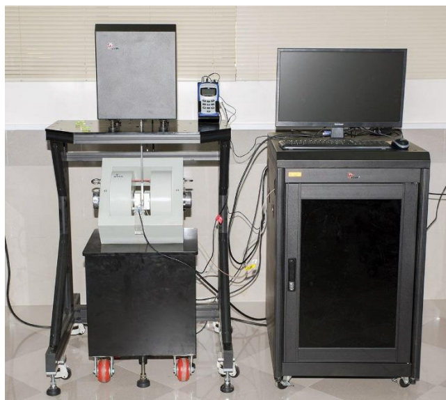
شکل ۴-۳: دستگاه مغناطیس سنج ارتعاشی (VSM) واقع در دانشگاه صنعتی شاهرود
