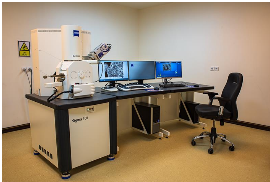
شکل ۳-۲: دستگاه میکروسکوپ الکترونی روبشی گسیل میدان (FESEM) واقع در دانشگاه صنعتی شاهرود
