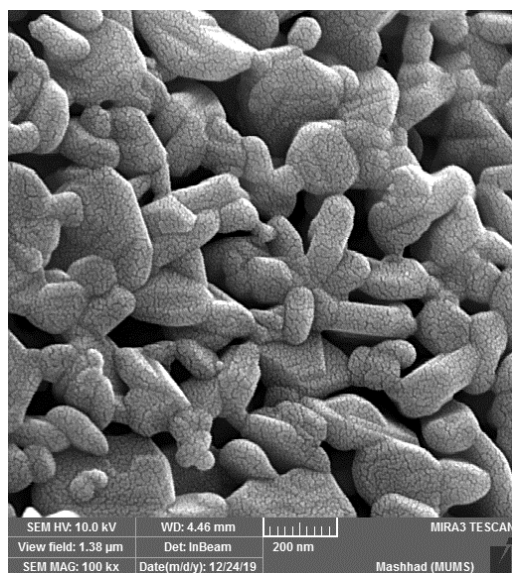
شکل ۷-۴ تصاویرهای FESEM فریت شش گوشه استرانسیوم تهیه شده با روش سل ژل خود احتراقی و پخت داده شده در دمای ۹۰۰ درجه سانتی گراد.
