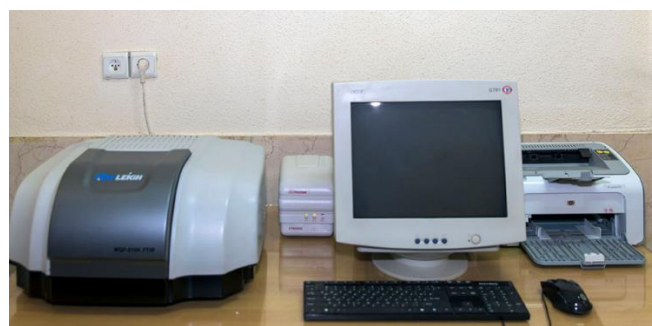
شکل ۱۰-۲: دستگاه طیف سنجی تبدیل فوریه مادون قرمز ساخت Rayleigh چین در دانشگاه صنعتی
