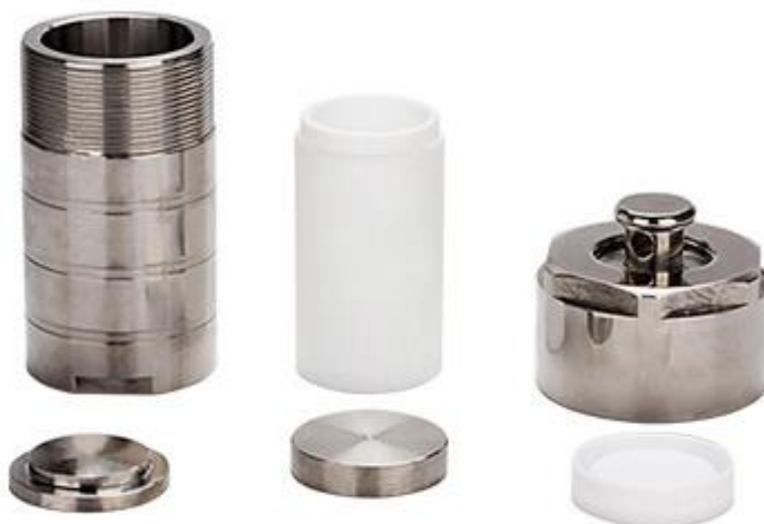
شکل ۲-۱: راکتور اتوکلاو به همراه ظرف تفلونی جهت انجام واکنش گرما آبی [۲۳]
