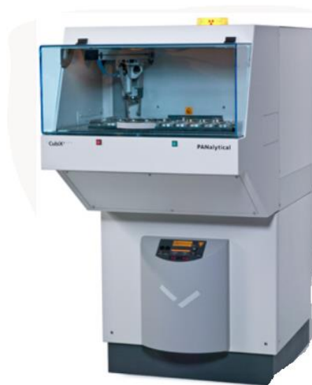
شکل ۲-۴: دستگاه پراش سنج پرتو ایکس PANalytical-pw1730 مورد استفاده در این پایان‌نامه
