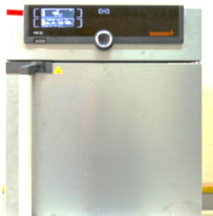
شکل ۲-۸: کوره محفظه‌ای ساخت شرکت memmert آلمان واقع در دانشگاه صنعتی شاهرود
