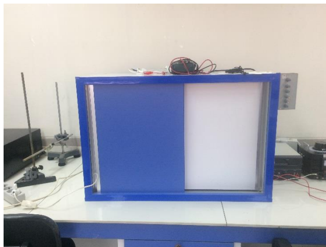
شکل ۲-۱۱: سیستم نورتابی جهت انجام فعالیت فوتوکاتالیستی استفاده شده در این پایان نامه
