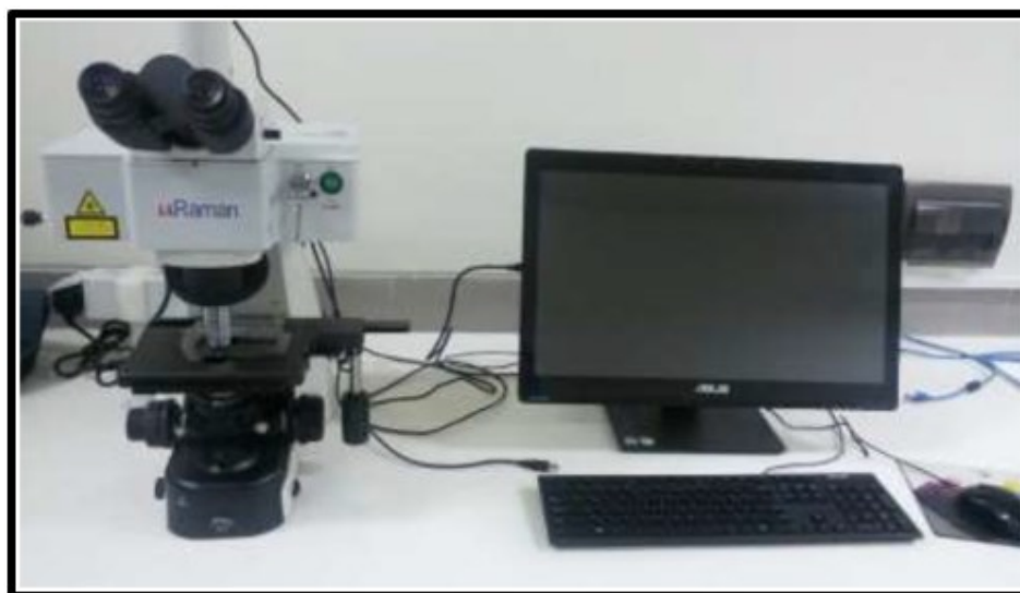
شکل ۲-۴: تصویری از دستگاه طیف سنجی رامن موجود در دانشگاه صنعتی شاهرود.
