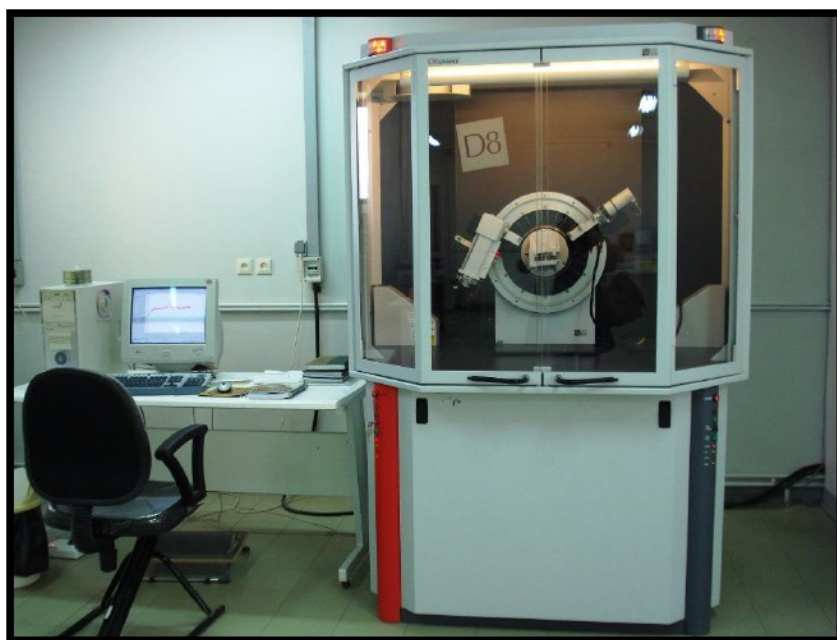
شکل ۲-۲: دستگاه پراش پرتو ایکس مورد استفاده جهت مطالعه ساختاری لایه ها.
