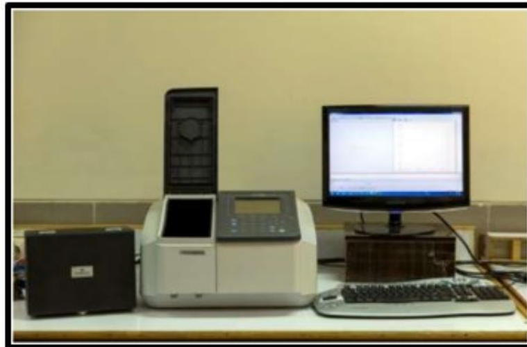
شکل ۲-۵: تصویر از دستگاه اسپکتروفوتومتر مدل Shimadzu-UV-1800 ، در دانشگاه صنعتی شاهرود جهت مشخصه‌یابی اپتیکی نمونه‌ها
