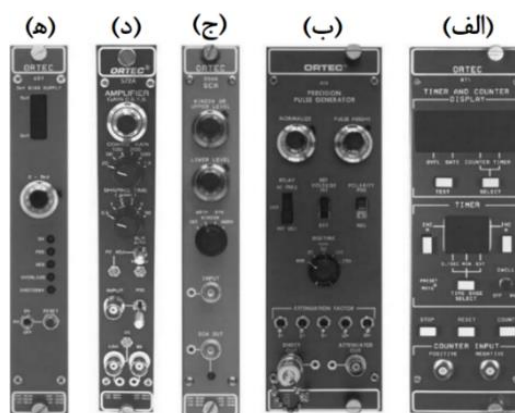
شکل (۱-۷) ماژول‌های NIM (الف) شمارنده و زمان‌سنج، (ب) مولد پالس، (ج) تحلیگر تک-کاناله، (د) تقویت کننده، (ه) منبع تغذیه ولتاژ بالا [۸].
