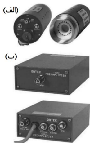
شکل (۱-۹) دو پیش تقویت کننده‌ی تجاری شرکت ORTEC: (الف) نوعی که با یک تکثیرکننده فوتون بکار می‌رود، (ب) نوعی که با آشکارسازهای نیم‌رسانا بکار می‌رود [۸].
