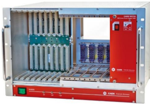
شکل (۲-۲) قفسه‌ی ترکیبی VME و NIM شرکت CAEN مدل NV8020A [۴۳].
