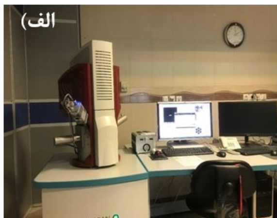
شکل ۲-۳ الف) میکروسکوپ الکترونی روبشی گسیل میدانی (FESEM) بکار گرفته شده در مورفولوژی سطح نمونه‌ها، واقع
