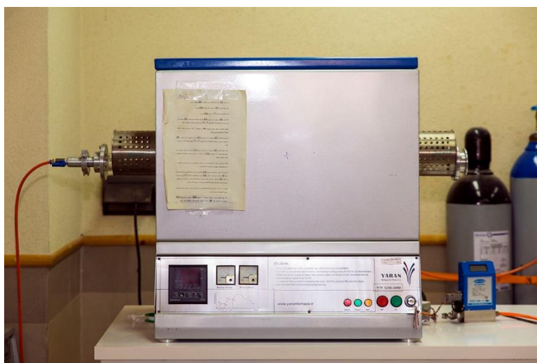
شکل ۳-۴ تصویر کوره تیویی ۱۱۰۰ °C استفاده شده جهت بازپخت نمونه‌ها واقع در دانشگاه صنعتی شاهرود
