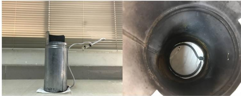
شکل ۳-۳ محفظه استفاده شده برای پاکسازی محیط از هوا با استفاده از نیتروژن
