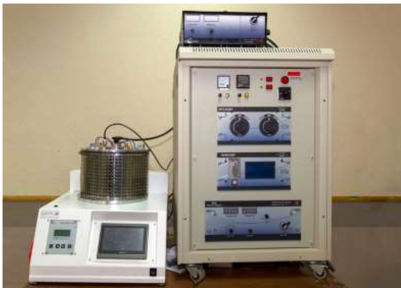
شکل ۳-۱: دستگاه کندوپاش استفاده شده در این تحقیق موجود در دانشگاه صنعتی شاهرود مدل DST3_A-Desk sputter coater
