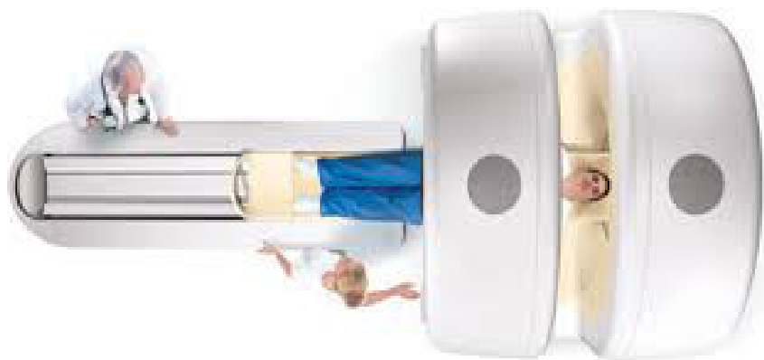
شکل ۲-۱۲: تصویر یک دستگاه پت/سی تی (حلقه‌ی اول که بیمار به آن وارد می‌شود سی تی و حلقه‌ی دوم پت است)
