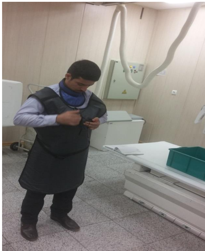
شکل (۳-۷): نمایی از محل قرار گرفتن دزیمر در بین روپوش و بدن آزمایشگر
